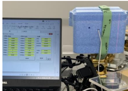
温度特性試験を行う際の装置
