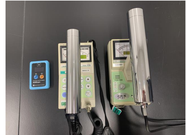
左：教育用放射線計測機 KINDpro 中：NaIシンチレーションサーベイメータ TCS-172 右：NaIシンチレーションサーベイメータ TCS-161
